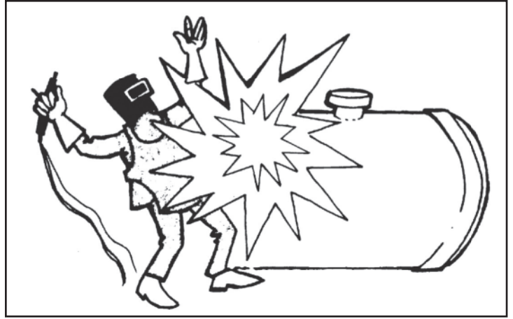
Fig. 1 - Explosion due à un dégazage incomplet
